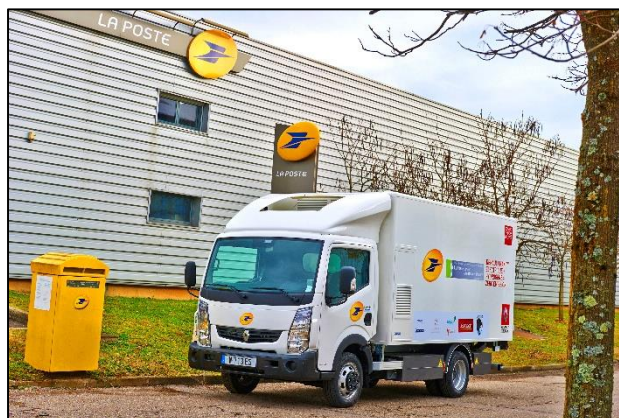
Figura 12: Il camion elettrico dotato di range extender ad idrogeno in fase di testing presso il servizio postale francese
